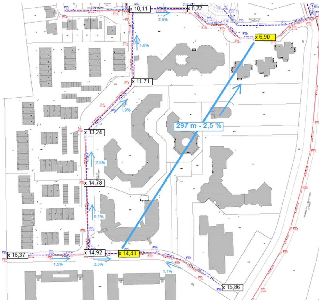
Abbildung 8: Grobe Skizzierung der Notwasserwege im Bestand
